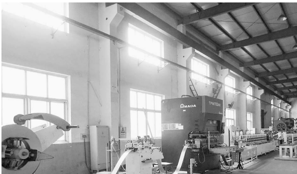
鋼板コイルをセットすれば製品が無人で生産される日本製最新鋼板フォーミング設備 ハイテムと協力工場の共同投資 フレーム関係部品製造に活躍
