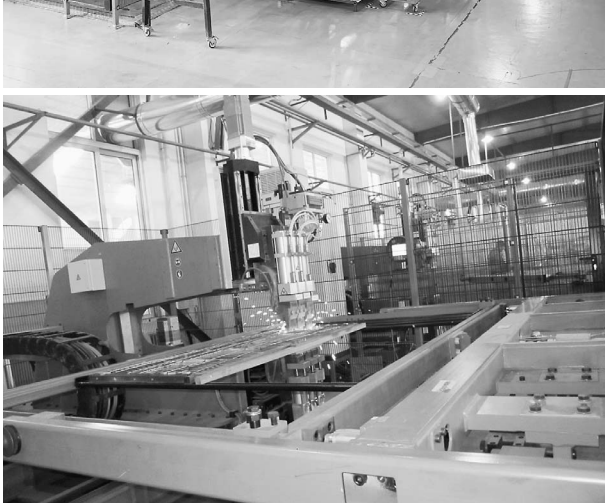
間仕切りなどのケージパーツを製造する溶接ロボット Ideal社（独）設備
