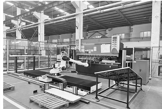
ベンダー加工設備ほかに鋼材を供給するロボット
