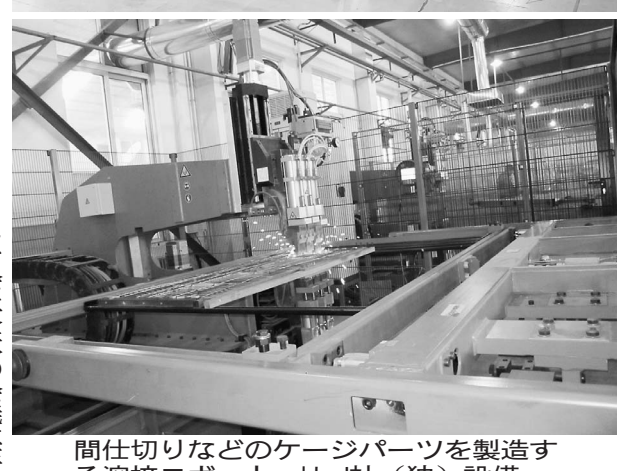
間仕切りなどのケージパーツを製造する溶接ロボット Ideal社(独)設備
