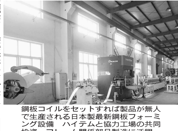
鋼板コイルをセットすれば製品が無人で生産される日本製最新鋼板フォーミング設備 ハイテムと協力工場の共同投資 フレーム関係部品製造に活躍
