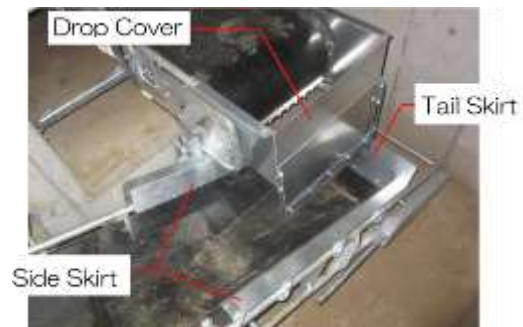
鸡粪转运处的防止鸡粪飞散构造
