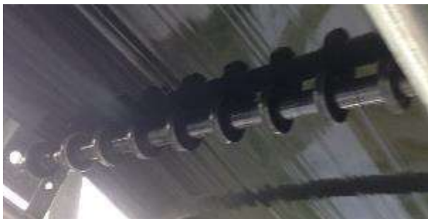
防止鸡粪沾粘的尼龙分隔式回程托辊
