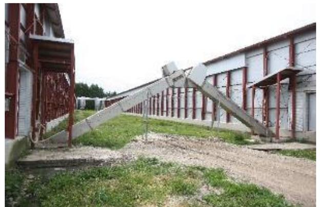
链式鸡粪传送机嵌于鸡舍尾端地沟中。封闭式结构便于保持周边环境清洁。其鸡粪的输送能力为鸡粪传送带的一半。承接鸡粪的传送机槽和链条的材质为 304 不锈钢，刮粪板为热镀锌材质。同时，由于链式传送机与粪沟无缝隙，故有助于防止害兽入侵。
