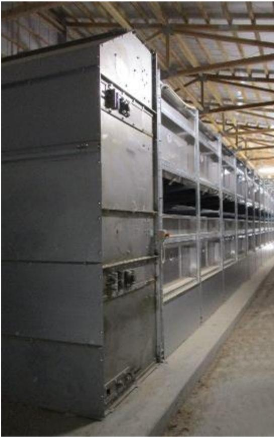
设备外壳与长时间接触高含水量鸡粪的上两层干粪板的材质为 304 不锈钢
