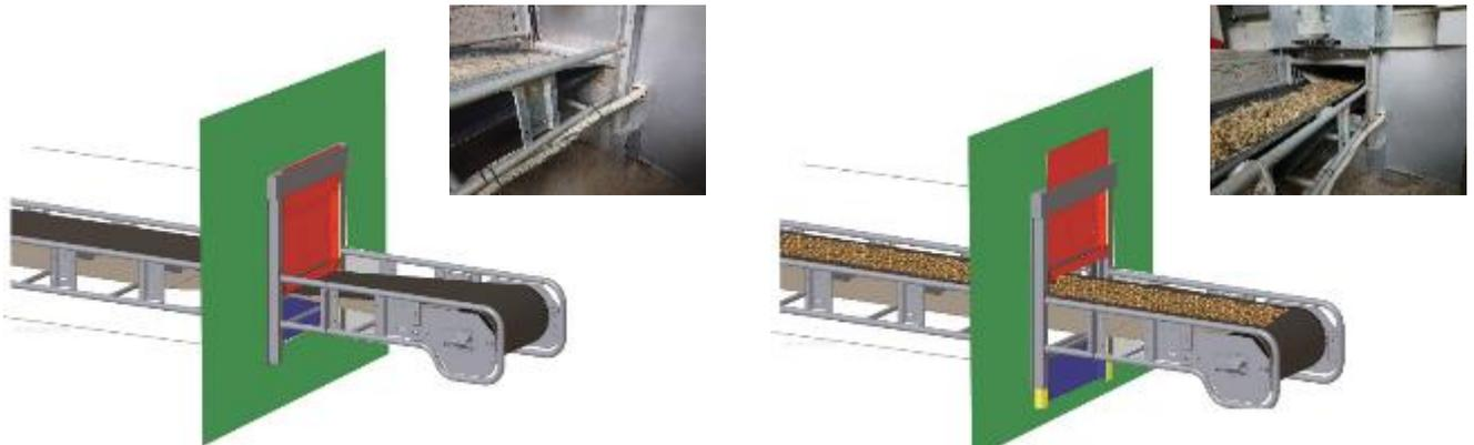
当清粪带停止时闸板自动关闭，防止老鼠等害兽的入侵。
